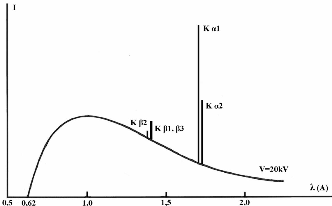
**Fig. II-4 : allure générale du spectre d'émission d'une anticathode de cuivre**
