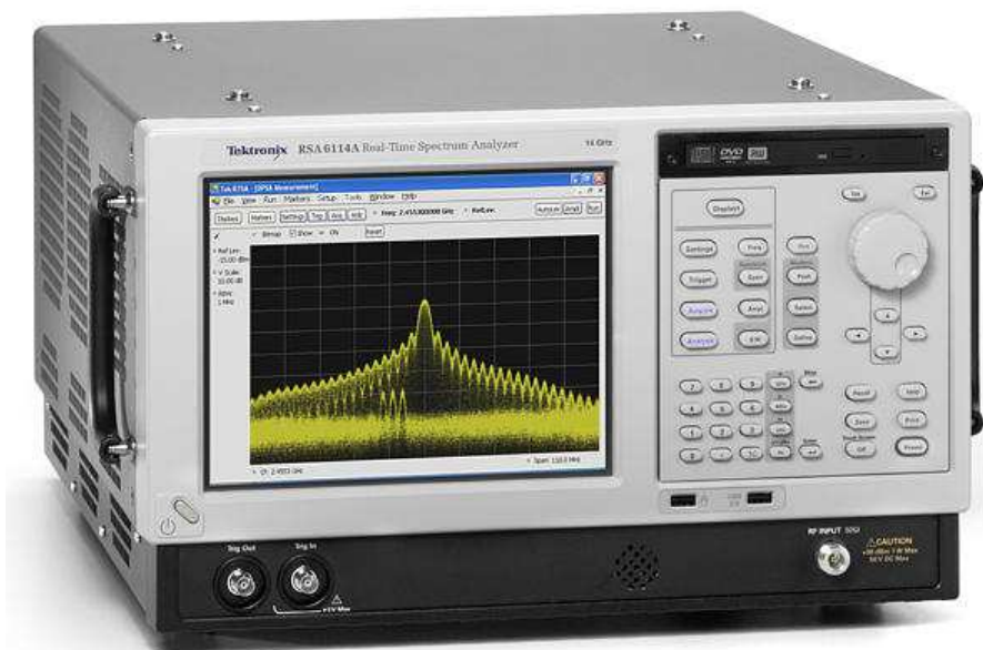
FIGURE 5.24 – Analyseur de spectre numérique Tektronix (Source photo http://www.tek.com )
