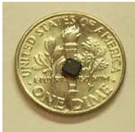
FIGURE 6.9 – Réalisation possible d'un filtre FIR
