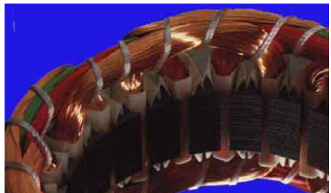
Détail de têtes de bobines
