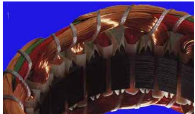
Détail de têtes de bobines
