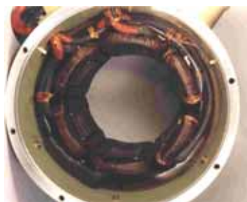
Diamètre extérieur 250 mm, entrefer : 150 mm
