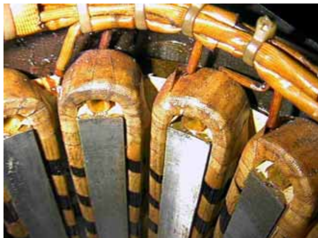
Stator de moteur à réluctance à double saillance (bobines concentrées)
