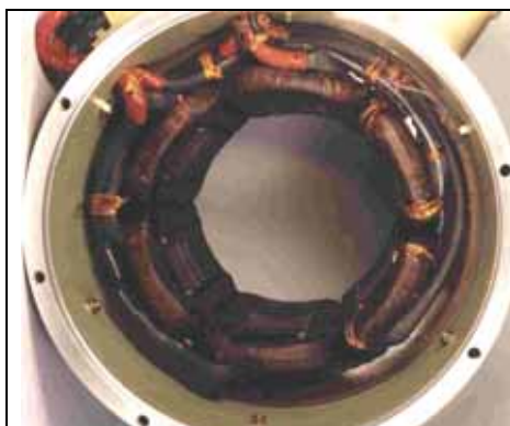
6 pôles saillants bobinés \phi 250 mm
