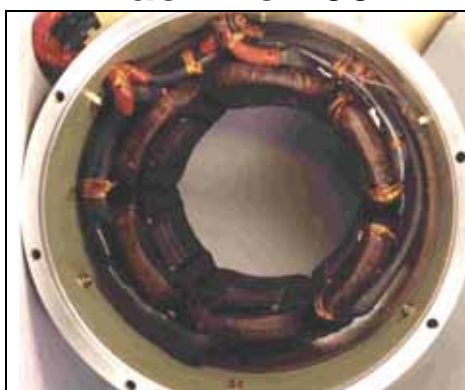
6 pôles saillants bobinés \phi 250 mm
