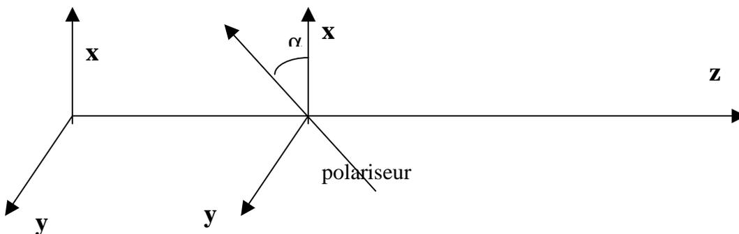
Considérons maintenant (figure ci dessous) un polarimètre constitué d'une lame demi onde introduisant un déphasage  $\pi$  et dont les axes font un angle  $\alpha$  avec les axes  $ox$  et  $oy$  (azimuth  $\alpha$ ), suivi d'un polariseur  $P_{ox}$  fixe et orienté selon l'axe  $ox$ .
