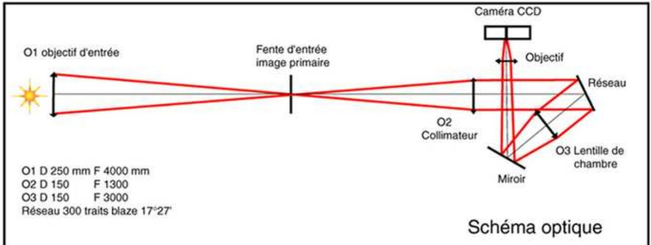
Le spectrohéliographe de Meudon est composé d'une lunette de 0.25 m d'ouverture (objectif O1) et de  $f = 4$  m de focale. Cette lunette alimente un spectrographe à fente dont le miroir collimateur a une focale  $f_1$  de 1.3 m (O2) ; l'objectif de chambre (O3) a une focale  $f_2$  de 1 m. L'élément dispersif est un réseau de diffraction de 300 traits/mm et d'angle de baze  $17^\circ$ . L'angle d'incidence sur le réseau vaut  $i = 7^\circ$ , et l'angle de diffraction est voisin de  $27^\circ$ .
