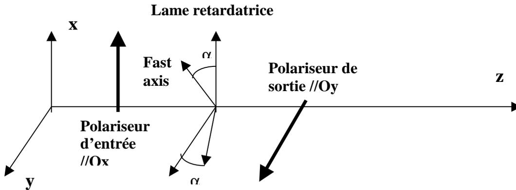
Ecrire la matrice de Müller de ce dispositif  $P_{oy} T_{\alpha,\delta} P_{ox}$  et montrer que l'intensité émergente du polariseur de sortie est égale à  $I = \frac{1}{2} I_0 \sin^2(2\alpha) \sin^2(\delta/2)$  si l'on suppose que le vecteur de Stokes de la source lumineuse (une lampe) est égal à  $(I_0, 0, 0, 0)$ . Montrer que l'on obtient l'extinction pour  $\alpha = 0$  modulo  $\pi/2$ , quelque soit le retard  $\delta$ .
