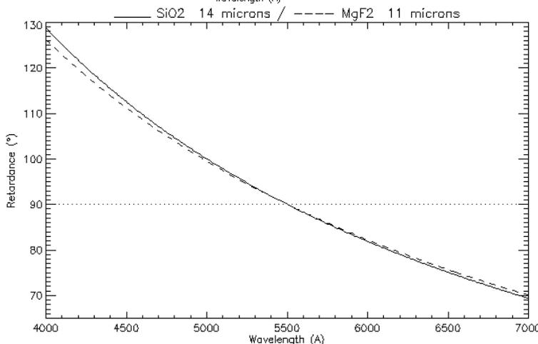
Retard  $\delta = (2\pi/\lambda)(n_e - n_o)e$  pour une lame de quartz d'épaisseur  $e = 14\ \mu$  — et pour une lame de  $MgF_2$  d'épaisseur  $e = 11\ \mu$  ----- en fonction de la longueur d'onde. L'épaisseur  $e$  a été calculée pour que  $\delta = \pi/2 = 90^\circ$  à  $\lambda = 5500\ \text{Å}$ . On remarque que le retard varie considérablement de  $130^\circ$  à  $70^\circ$  entre 4000 et 7000 Å. La lame présente donc un fort chromatisme.
