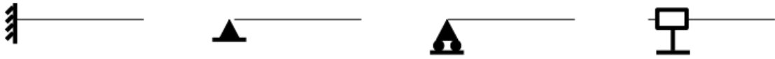
Figure 4.1: La symbolique des liaisons 2d utilisée dans ce cours (non normalisée) de gauche à droite : encastrement 2d, appui simple 2d, appui sur rouleau 2d, glissière 2d. L'axe \vec{i} est horizontal vers la droite, \vec{j} est vertical ascendant et \vec{k} est sortant de la feuille.
