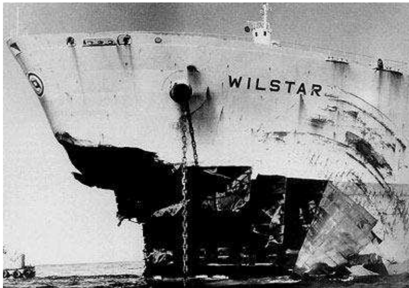
Etrave détruite par une vague scélérate.
