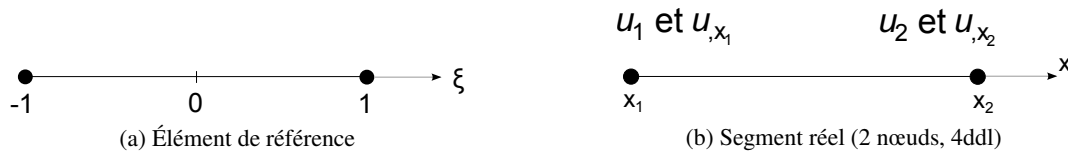
FIGURE 12.14: Élément de barre unidimensionnel de type Hermite
