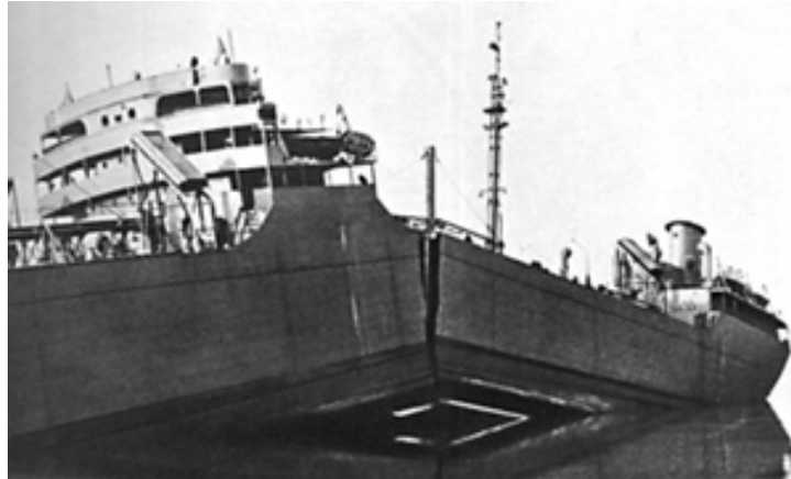
FIGURE 3.11 – Le Schenectady, un des liberty ships entièrement rompus
