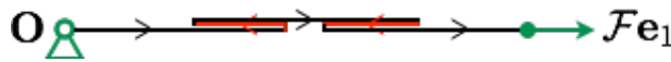
FIGURE 4.4 – Configuration d'équilibre solution du problème aux limites avec des zones comprimées (en rouge).
