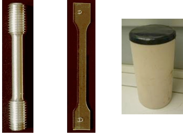
FIGURE 3.1 – Eprouvettes utilisées dans des essais uni-axiaux : à gauche et au milieu, épreuve à section circulaire et épreuve plate pour un essai de traction ; à droite, épreuve cylindrique pour un essai de compression.
