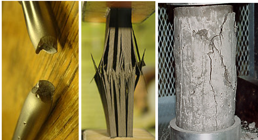
FIGURE 3.6 – Etat final de différentes éprouvettes après un essai uniaxial : à gauche, rupture par striction d'une éprouvette métallique ; au centre, rupture par décohésion des fibres d'un composite à fibres de carbone ; à droite, rupture par fissuration longitudinale d'une éprouvette de béton comprimé.
