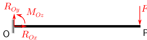
FIGURE 6.4 – Définition des réactions d'appuis
