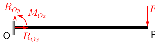
FIGURE 6.4 – Définition des réactions d'appuis
