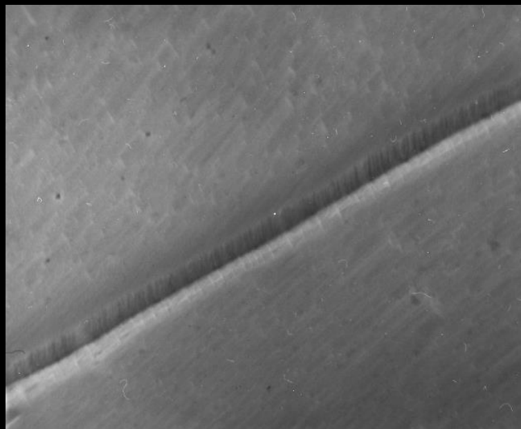
Sillon observé à la surface d'un bicristal de NiO ( \theta=20^\circ )
