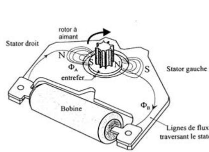
Moteur Lavet utilisé dans les montres (aimant bipolaire de moins de 1 mm de diamètre, terres rares pour minimiser la consommation)
