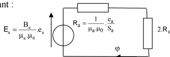
$$R_a = \frac{1}{\mu_a \cdot \mu_0} \cdot \frac{e_a}{S_a} \text{ avec } S_a = h_a \cdot L \text{ (L = longueur axiale)}$$
