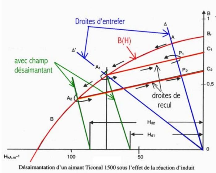
Les droites d’entrefer correspondent aux caractéristiques du circuit magnétique externe (voir la littérature courante), L’intersection avec la caractéristique Ba(Ha) de l’aimant donne le point de fonctionnement.
