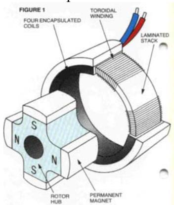
Moteur à débattement limité (bobinage monophasé de Gramme : sans encoches pour éviter un couple de détente)
