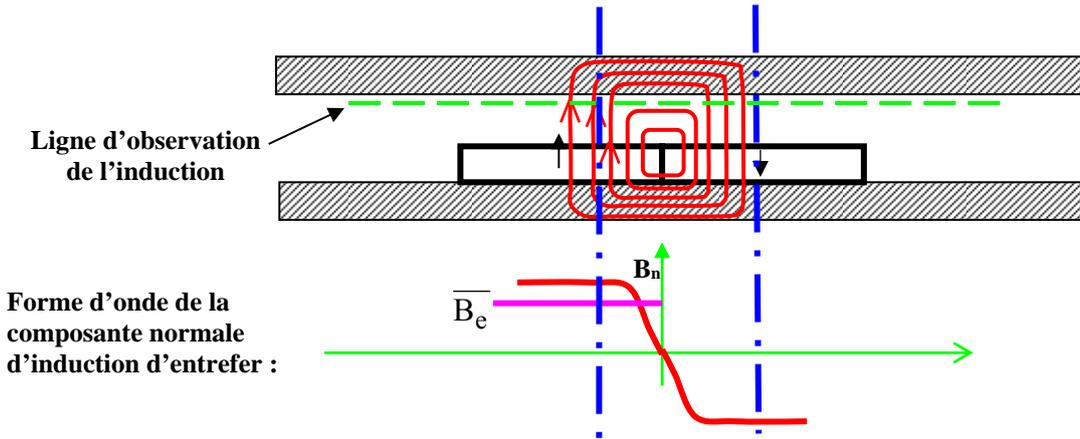
Les fuites conduisent à une diminution de la valeur moyenne (sous un pôle) composante normale de l'induction donc à une diminution du flux inducteur.
