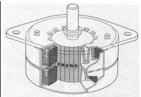
Moteur pas à pas dit à aimants permanents : stator diphasé à griffes (bobinage global par phase) et rotor multipolaire (souvent 12 paires de pôles, donc 48 pas par tour avec 2 phases)
