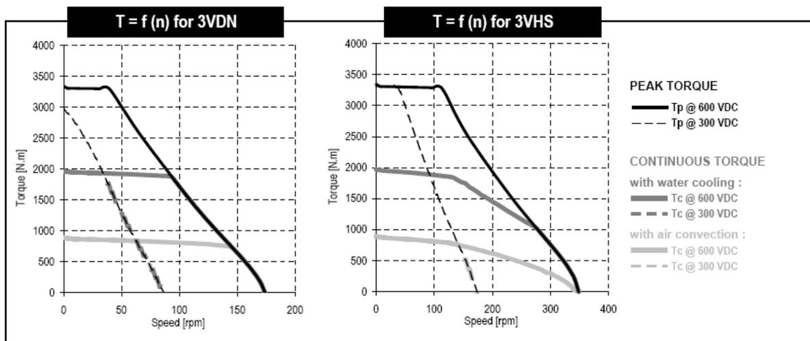
On remarquera l'effet de la tension d'alimentation du bus continu (300 ou 600 V) sur les caractéristiques de couple impulsionnel ou continu (thermique) ainsi que celui du bobinage (2 nombres de spires variant dans un rapport 1 à 2).
