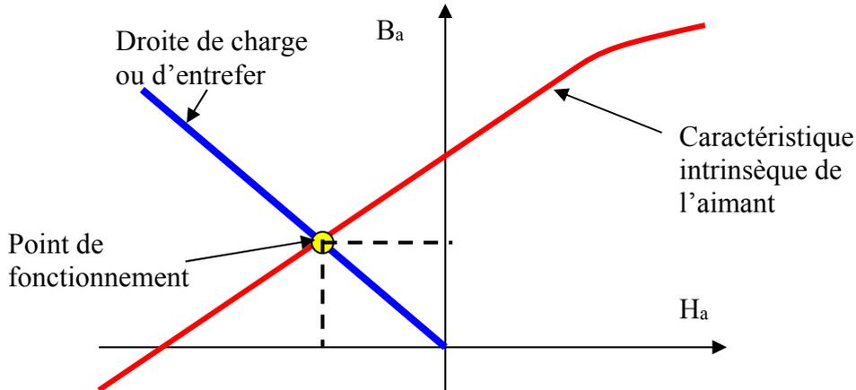
La présence d'un entrefer dans le circuit magnétique contribue à réduire la valeur de l'induction dans l'aimant par rapport à son induction rémanente, d'où l'appellation « charge ». Si l'entrefer varie (effets d'encoches ou réluctance variable avec aimants), la pente de la droite de charge fluctue et fait varier le point de fonctionnement, ce qui peut avoir, entre autres effets, de créer des pertes magnétiques dans l'aimant.
