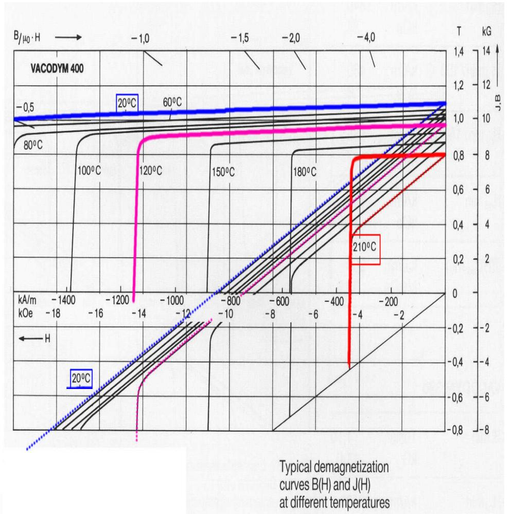
Un champ désaimantant de 2150 A/m correspond avec une perméabilité relative de 1,04 environ à une excursion totale d'induction de - 2,8 T à 20°C entre le fonctionnement en court-circuit (flux maximal de l'aimant) et la limite de désaimantation. Notons que cette excursion tombe à 1,26 T (0,45 T 350 kA/m) à 210°C.
