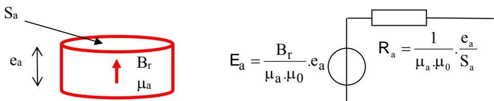
Bien sûr ce schéma peut être transformé en générateur de Norton avec source de flux ( $B_a \cdot S_a$ ) et réluctance en parallèle. Maintenant, l'aimant est représenté comme un générateur, donc en convention générateur.
