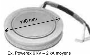
Ex. Powerex 6 kV – 2 kA moyens et 6 kA commutables (130 kVA/cm 2 )
