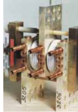
assemblage de boîtiers Press-Pack refroidis à l'eau (Westcode à gauche)
