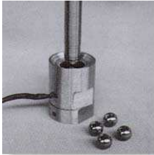
Figure 2 : vue d'ensemble d'une machine quatre billes.
