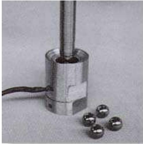
Figure 2 : vue d'ensemble d'une machine quatre billes.
