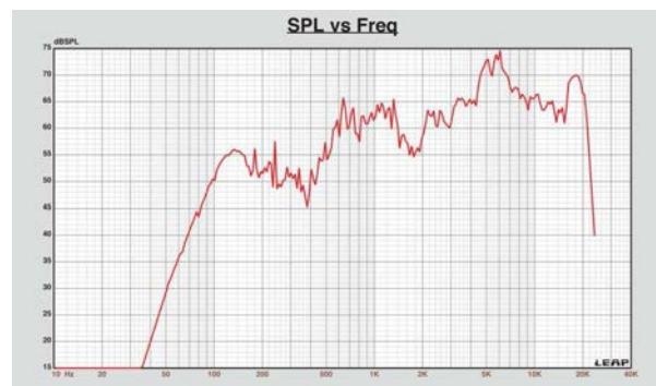
FIG. 6.9 – Réponse en fréquence d'un haut-parleur.
