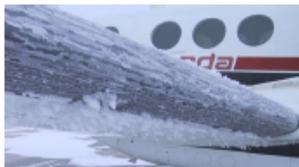
Figure 1 : Phénomène de givrage des bords d'attaque d'ailes d'avions.
