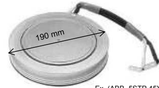
Ex. (ABB 5STP 45Y8500) 8,5 kV – 4,24 kA moyens (130 kVA/cm 2 )
