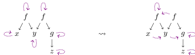
FIGURE 8. Étape (2) de l'algorithme d'unification sur les termes d'entrée f(x, y) et f(g(y), g(z)) .
