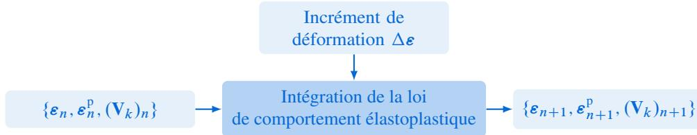
**Figure 4.3** – Intégration de la loi de comportement élastoplastique en un point de Gauss. Les contraintes  $\boldsymbol{\sigma}$  et les forces thermodynamiques  $\mathbf{A}_k$  sont des variables dépendantes de la déformation plastique  $\boldsymbol{\varepsilon}^p$  et des variables internes  $\mathbf{V}_k$  au travers des lois d'état.
