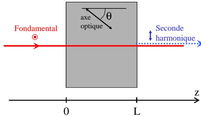
Exprimer l'indice de réfraction vu par la seconde harmonique,  $n_e(\theta, 2\omega_0)$ , d'une part en fonction de  $n_o(2\omega_0)$  et  $n_e(2\omega_0)$ , et d'autre part en fonction de l'indice vu par le fondamental,  $n_o(\omega_0)$  (l'accord de phase étant supposé vérifié pour la longueur d'onde centrale de l'impulsion). En déduire la valeur de l'angle  $\theta$ . Application numérique.
