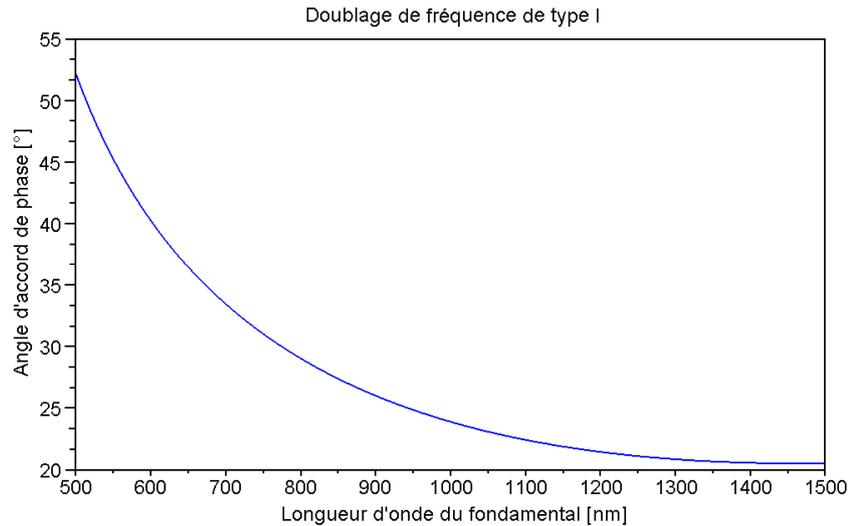
**Figure C.7:** Courbe d'accord de phase dans un cristal de BBO pour un doublage de fréquence de type I en fonction de la longueur d'onde du fondamental.
