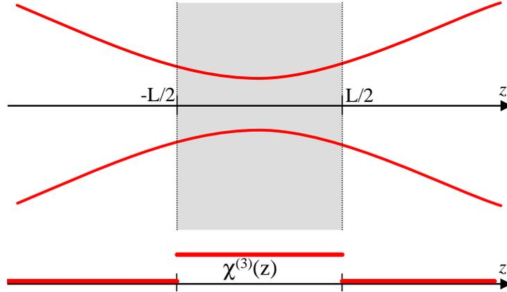
On supposera que les indices de réfraction  $n_1$  et  $n_3$  sont identiques dans le verre et le liquide, de sorte que les équations de propagation restent valables à condition de remplacer  $\chi^{(3)}$  par une fonction supposée connue  $\chi^{(3)}(z)$ . Ainsi la fonction  $\mathcal{A}_1(x, y, z)$  discutée à la question précédente reste solution de l'équation de propagation et sera utilisée dans toute la suite.
