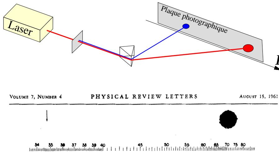
**Figure 3.1:** Première observation du phénomène de doublage de fréquence [11]. Le faisceau transmis par le cristal non-linéaire est dispersé à l'aide d'un prisme afin d'isoler la composante à  $2\omega$ . L'image du faisceau doublé, normalement présente sous la flèche, a malencontreusement été effacée car confondue avec une tache lors de l'édition du manuscrit par *Physical Review Letters*.
