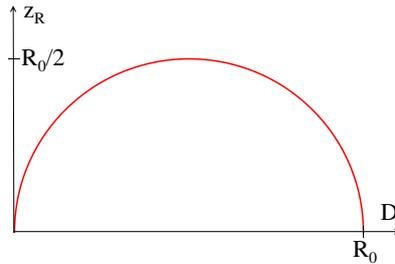
**Figure 4.4:** Zone de stabilité de la cavité
