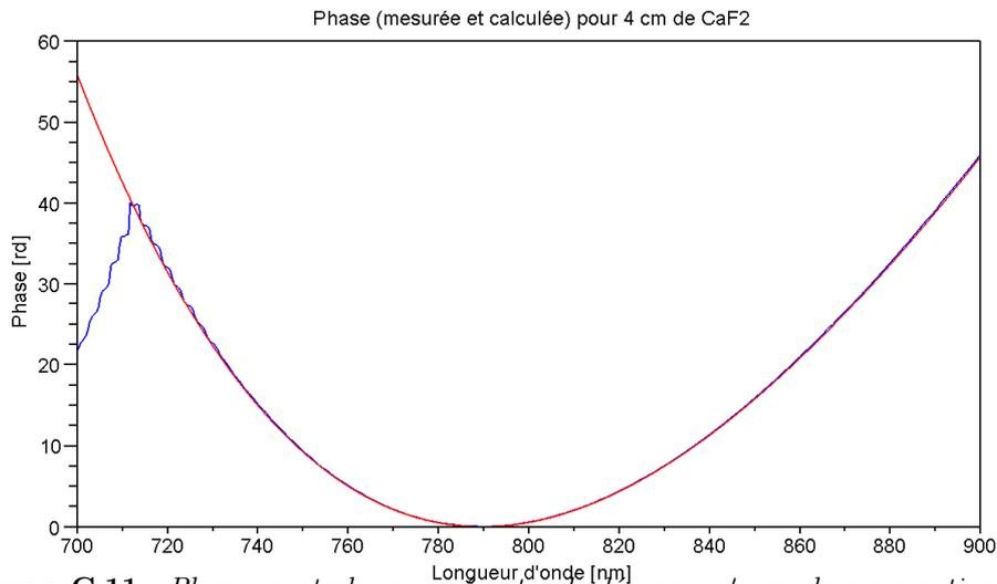
Figure C.11: Phase spectrale mesurée et calculée pour 4 cm de propagation dans  $\text{CaF}_2$ . Les termes constants et linéaires de la phase - qui ne sont pas accessibles à l'expérience - ont été soustraits.
