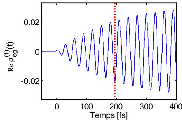
**Figure 6.2:** Cohérence induite au premier ordre dans un système à deux niveaux excité par une impulsion résonnante de forme rectangulaire et de durée 2 ps.  $T_1 = T_2 = 200$ fs.  $2\pi/\omega_{eg} = 30$ fs
