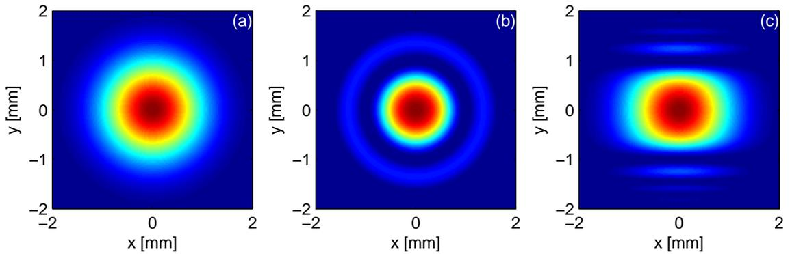
**Figure 5.5:** Figures d'interférence obtenues entre un faisceau de référence de phase spatiale plate et un faisceau de phase spatiale  $\varphi(x, y)$ . Les deux faisceaux sont supposés gaussiens avec  $w = 1$  mm et (a)  $\varphi(x, y) = 0$ , (b)  $\varphi(x, y) = \pi(x^2 + y^2)/w^2$  et (c)  $\varphi(x, y) = \pi y^3/w^3$ . Les deux faisceaux sont colinéaires.
