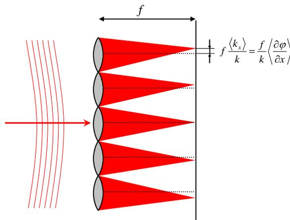
**Figure 5.8:** Schéma de principe du dispositif de Shack-Hartmann. Si la déformation du front d'onde est suffisamment faible, on peut considérer que chaque micro-lentille focalise une mini onde plane dont le vecteur d'onde transverse est simplement le gradient de la phase spatiale du faisceau, ce qui produit un déplacement proportionnel du point focal produit.
