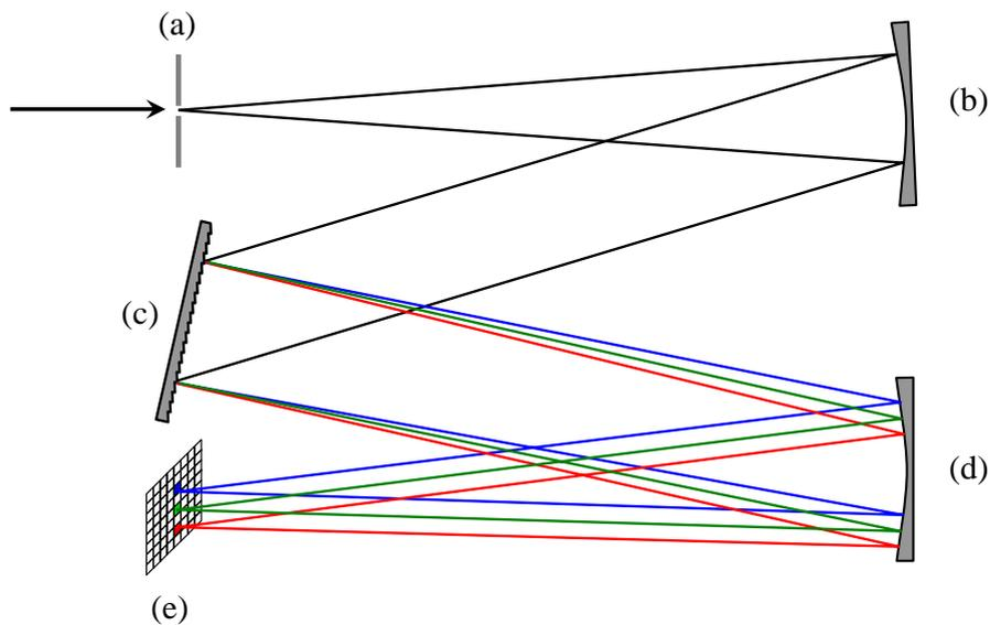
**Figure 5.3:** Schéma de principe d'un spectromètre à réseau
