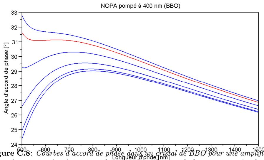
**Figure C.8:** Courbes d'accord de phase dans un cristal de BBO pour une amplification paramétrique en géométrie non colinéaire. L'angle entre le faisceau injecté et la pompe varie par pas de  $1^\circ$  de  $0^\circ$  (courbe du bas) à  $4^\circ$  (courbe du haut). La courbe en rouge correspond à un angle de  $3.7^\circ$ .
