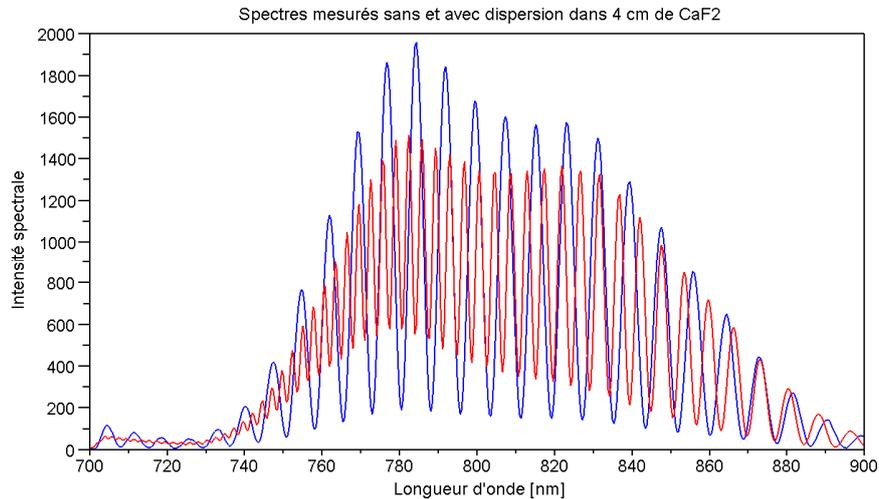
**Figure C.9:** Spectres mesurés dans un interféromètre en l'absence (en bleu) et en présence (en rouge) d'un bloc de CaF<sub>2</sub> de 2 cm d'épaisseur traversé deux fois par le faisceau laser (mesure effectuée par Guillaume Labroille - LOB).
