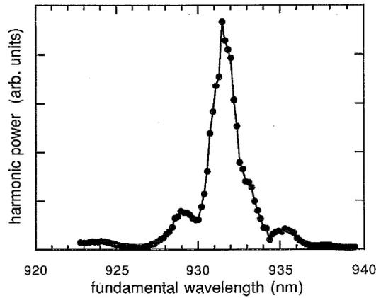
Interpréter la courbe obtenue et déterminer un ordre de grandeur de la largeur à mi-hauteur (que l'on comparera à la valeur expérimentale) sachant que l'épaisseur totale de l'échantillon est d'environ  $500 \mu\text{m}$  et que les indices de groupe à  $932$  et  $466 \text{ nm}$  sont respectivement égaux à  $2.32$  et  $2.74$ .
