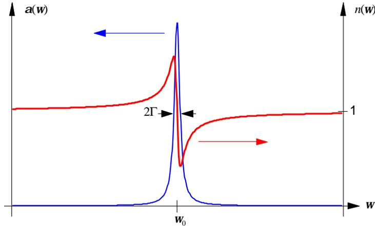
**Figure 2.1:** Représentation de l'absorption et de l'indice de réfraction obtenus à partir des éq. 2.35 et 2.36 dans le cas d'un système à deux niveaux de fréquence de transition  $\omega_0 = \omega_{eg}$  et de taux de déphasage  $\Gamma = \Gamma_{eg}$ .
