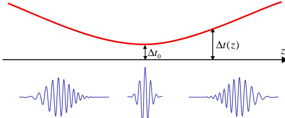
**Figure 1.3:** Représentation de la durée d'une impulsion brève au cours de sa propagation, montrant une variation hyperbolique, en parfaite analogie avec le diamètre d'un faisceau lumineux. La dispersion joue un rôle analogue à la diffraction.
