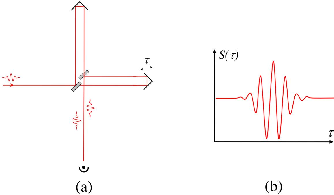
**Figure 5.4:** (a) Schéma de principe d'un spectromètre par transformée de Fourier. Chaque lame semi-transparente comporte un traitement diélectrique en face avant assurant une réflectivité de 50%, ainsi qu'un traitement anti-reflet en face arrière. (b) Exemple de signal mesuré en fonction du retard  $\tau$  dans le cas d'une source de grande largeur spectrale.
