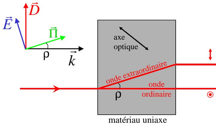
Figure 1.8: Illustration du phénomène de double réfraction
