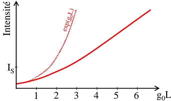
**Figure 4.6:** Intensité obtenue après amplification sur une Longueur  $L$ . La courbe en pointillé représente ce que l'on aurait obtenu en l'absence de saturation ( $g = g_0$ ).
