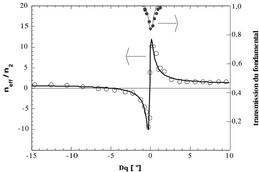
L'accord de phase est ici obtenu en exploitant la biréfringence du cristal. Les conditions d'accord de phase sont variées en inclinant le cristal par rapport au faisceau incident - l'axe des abscisses de la figure représente précisément l'angle  $\Delta\theta$ , l'accord de phase étant réalisé lorsque  $\Delta\theta = 0$ . On admet que  $\Delta\theta$  est alors proportionnel à  $\Delta k$  (on pourra éventuellement justifier brièvement ce dernier point).
