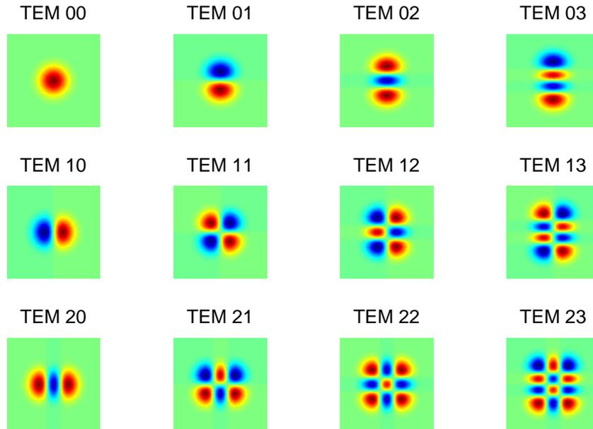
Figure 1.6: Profils transverses de faisceaux gaussiens d'ordre multiple.
