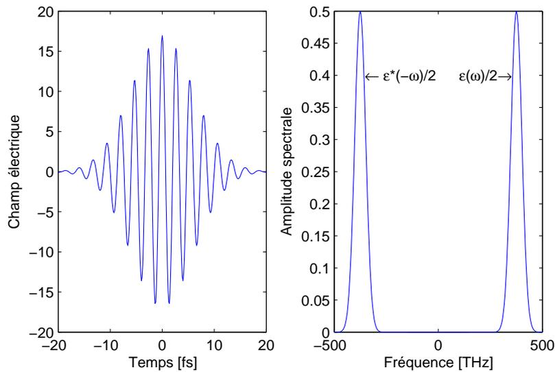
**Figure 1.1:** Profil temporel et spectral d'une impulsion gaussienne. La fréquence centrale est de 375 THz, ce qui correspond à une longueur d'onde de 800 nm. La largeur à mi-hauteur de l'intensité temporelle est de 10 fs.
