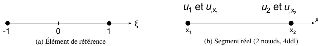
FIGURE 12.14: Élément de barre unidimensionnel de type Hermite
