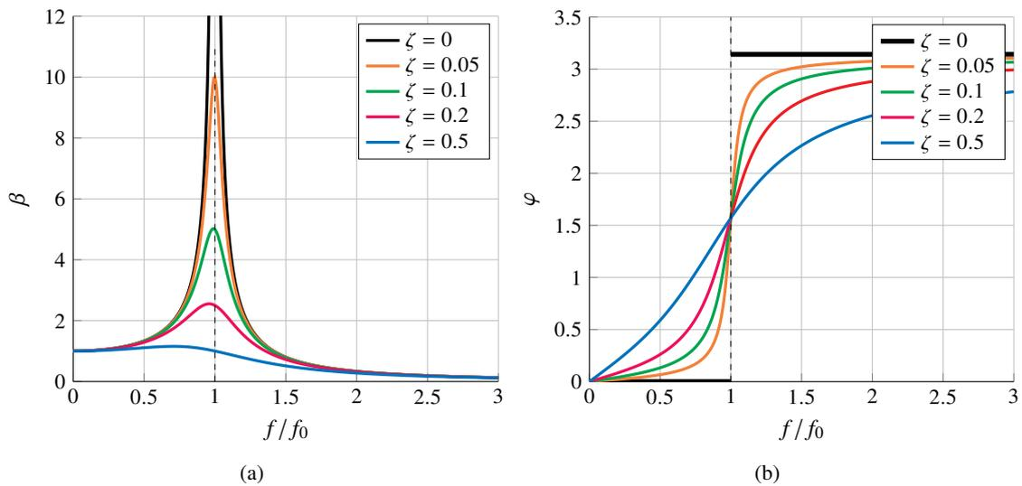
FIGURE A.5. (a) Variation fréquentielle du coefficient d'amplification dynamique : cas d'une excitation par force imposée. (b) Variation fréquentielle du déphasage.
