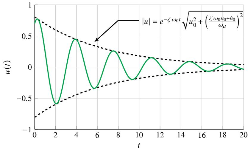
FIGURE A.4. Vibrations libres d'un oscillateur harmonique amortis (A.17) (ligne bleue pleine) et son amplitude  $|u|$  donnée par l'Éq. (A.19) (ligne noire pointillée) avec conditions initiales  $u(0) = s_0$  et  $\dot{u}(t) = \dot{s}_0$ .
