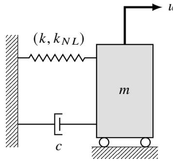
FIGURE 1.4. Système masse-ressort avec amortisseur visqueux et force de rappel non linéaire.
