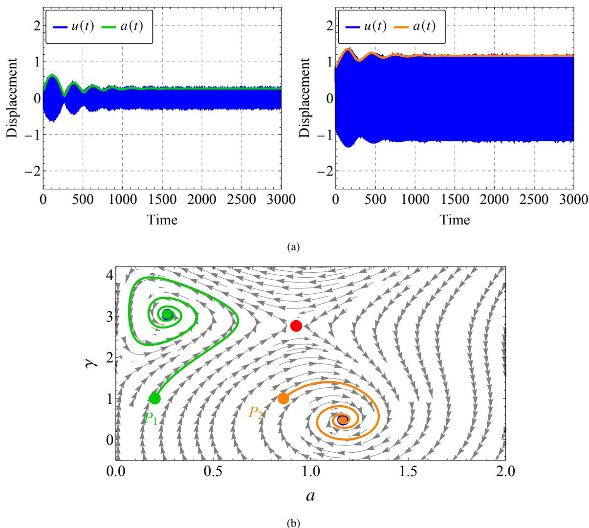
FIGURE 3.2. Intégration numérique des systèmes (3.6) et (3.16) pour  $\sigma = 3$  et pour deux conditions initiales  $P_1 = (0.2, 1)$  et  $P_2 = (0.86, 1)$ . La figure montre (a) l'amplitude en fonction du temps et (b) la trajectoire dans le plans  $(a, \gamma)$  comparé aux lignes de champ de (3.20). Les points bleus et rouge représentent respectivement les points fixes stables et instable. Même paramètres que dans la Fig. 3.1 avec  $\epsilon = 0.01$ .
