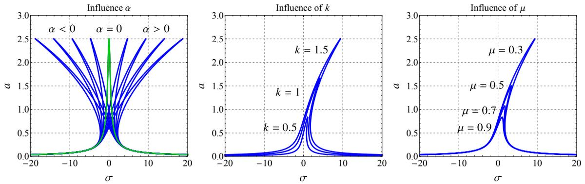
FIGURE 3.4. Évolution de l'allure du diagramme de bifurcation quand la raideur non linéaire  $\alpha$  (à gauche), l'intensité du forçage  $k$  (au centre) et le coefficient d'amortissement  $\mu$  (à droite) varient. Même paramètres que dans la Fig. 3.1 avec  $\epsilon = 0.01$ .
