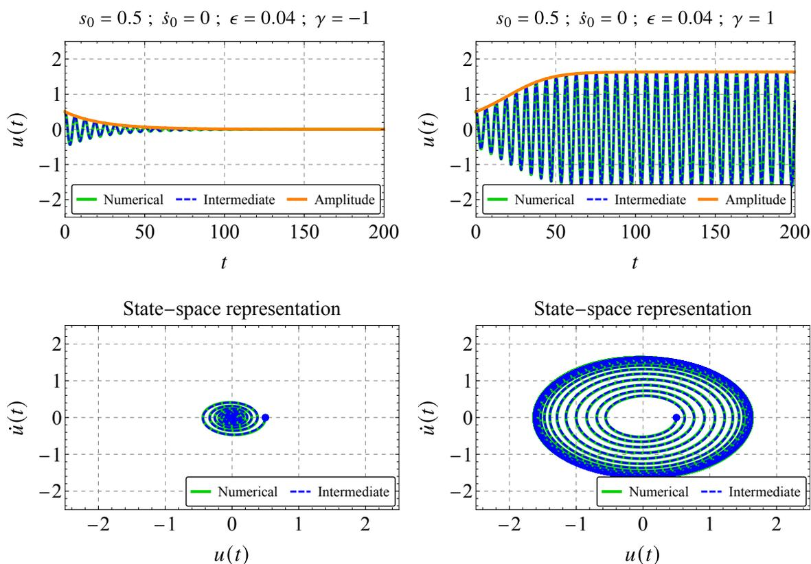
FIGURE 4.1. Comparaison entre l'intégration numérique du (4.4) et la solution théorique intermédiaire donnée par (4.40) avec  $\gamma = -1$  à gauche,  $\gamma = 1$  à droite,  $\alpha = 1$  et  $\epsilon = 0.04$ . En haut : Série temporelle. En bas : représentation dans l'espace des phases.
