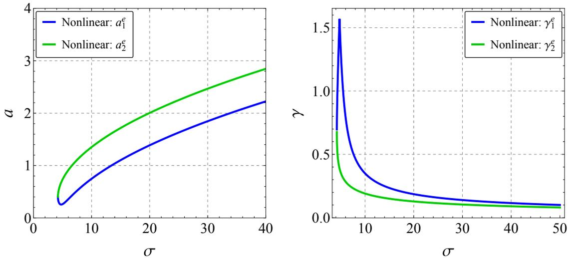
FIGURE 3.8. Points fixes de (3.43) : amplitudes  $a^e$  (à gauche) et phases  $\gamma^e$  (à droite). La paramètre suivantes sont utilisés :  $\mu = 0.3$ ,  $\alpha = 5$  et  $K = 5$ .
