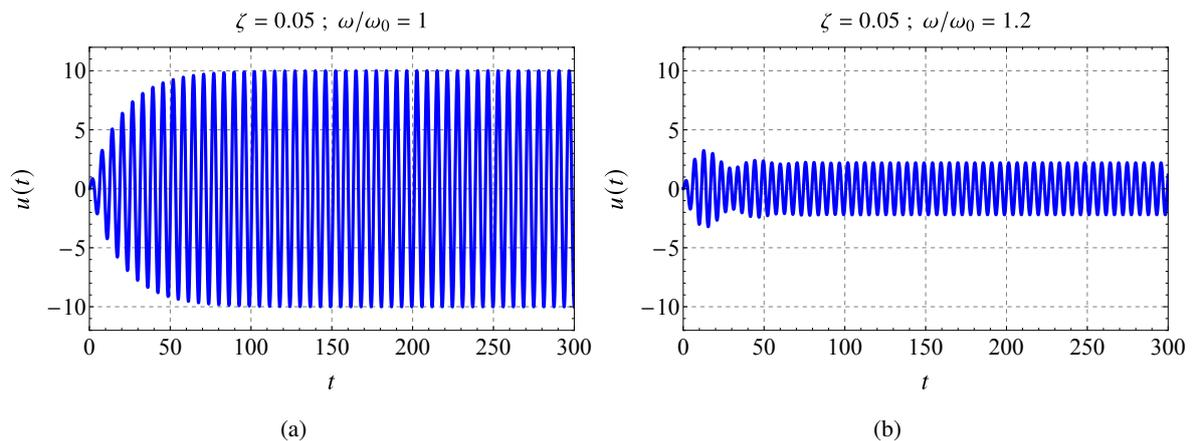
FIGURE A.6. Profil temporel de (A.27) pour  $\zeta = 0.05$  et pour deux valeurs de fréquence adimensionnée : (a)  $f/f_0 = 1$  et (b)  $f/f_0 = 1.2$
