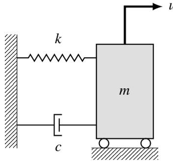
FIGURE A.3. Système masse-ressort avec amortisseur visqueux.
