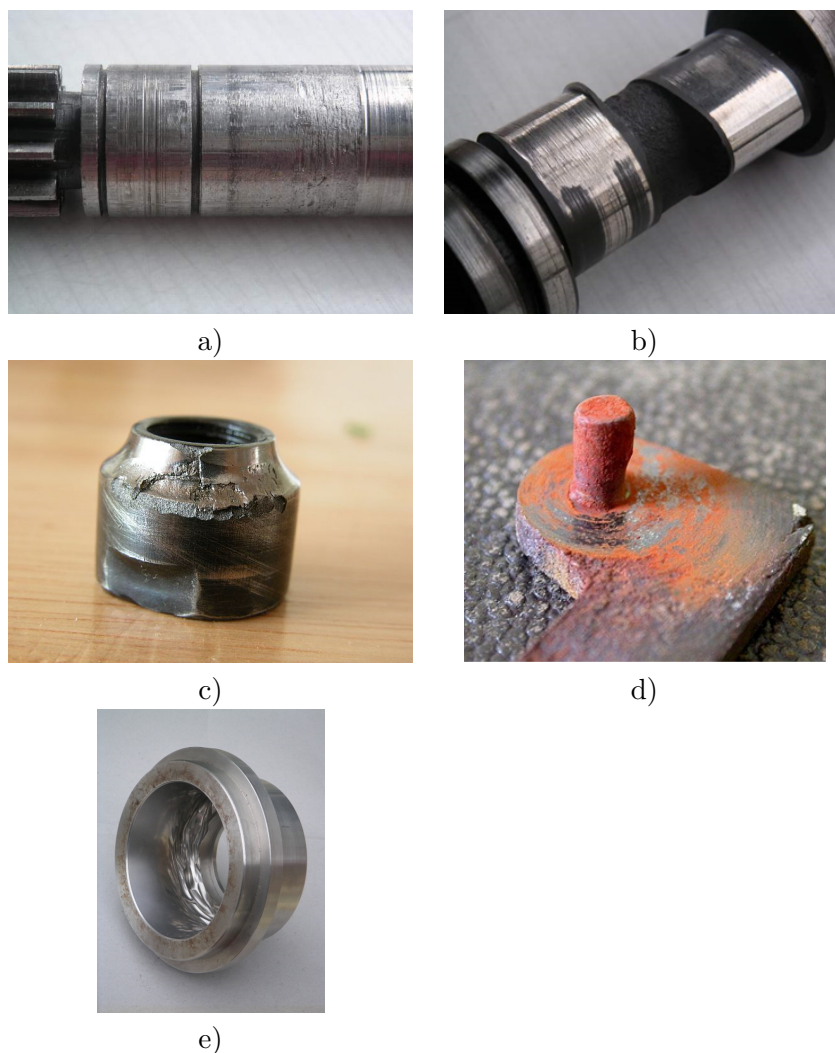
FIGURE 3.16 – Exemples de surfaces usées par différents mécanismes a) Adhésion a b) Abrasion b c) Fatigue superficielle c d) Corrosion d e) Erosion e
