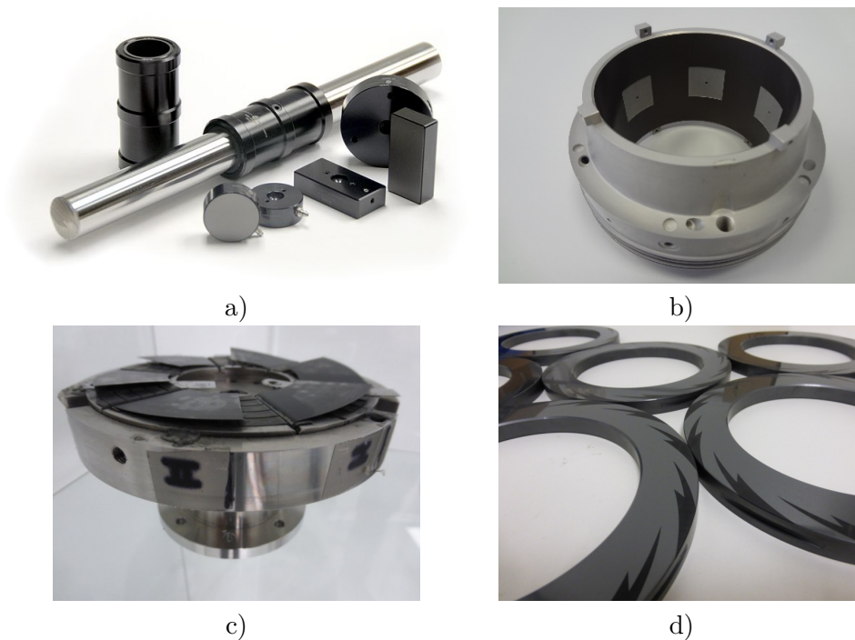
FIGURE 9.1 – Exemples de paliers et butées aérostatiques et aérodynamiques : a) Paliers et butées aérostatiques a , b) Palier aérostatique, banc mistral (source : Institut Pprime) b , c) Butée aérodynamique à feuilles (source : Institut Pprime), d) Garniture mécanique pour gaz (source : Institut Pprime)
