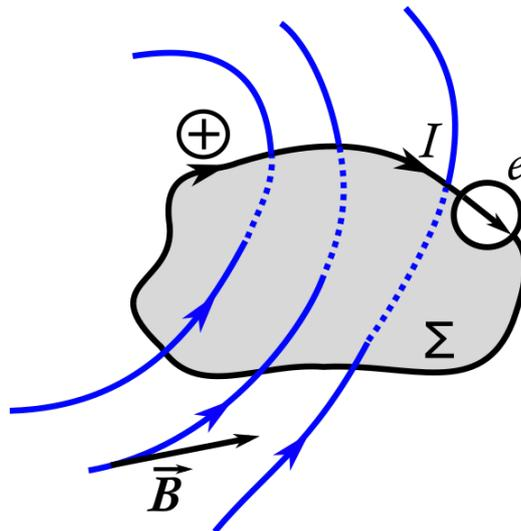
**Fig. IV.4.** Orientation d'une surface et d'un circuit filiforme fermé dans le contexte de l'induction électromagnétique. La variation de flux magnétique induit une f.e.m.  $e$ .
