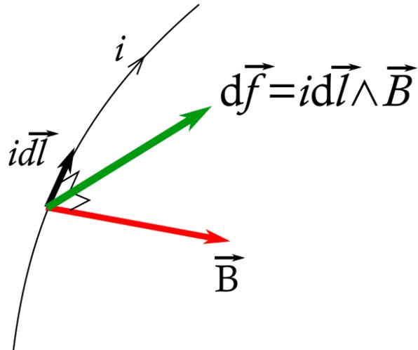
**Fig. IV.1.** Force de Laplace dans le cas d'un circuit filiforme.
