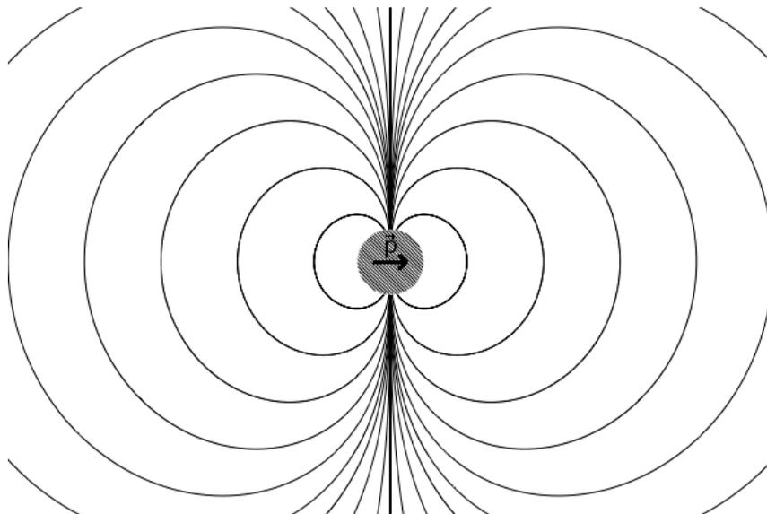
**Fig. II.4.** Equipotentiellles d'un dipôle électrostatique. Extrait de <https://commons.wikimedia.org/wiki/File:Equipotdipoleelec.png>.
