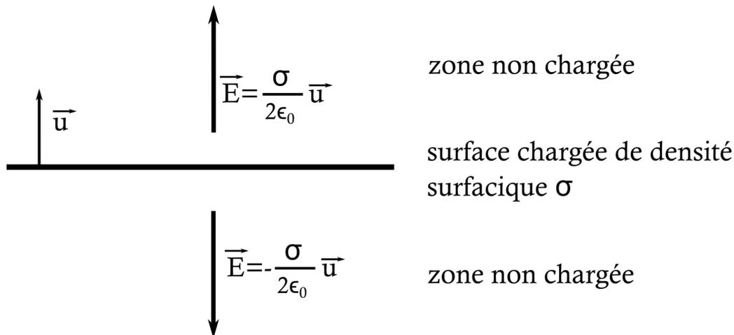
Fig. I.6. Champ d'une surface chargée infinie de charge surfacique  $\sigma$ .
