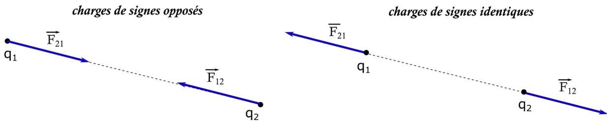
**Fig. V.1.** Forces électrostatiques entre deux charges ponctuelles.
