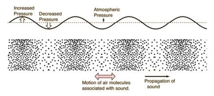
Une onde sonore se propage dans un milieu matériel : un gaz, un liquide, un solide. Une onde sonore ne se propage pas dans le vide. La grandeur physique qui se propage est une onde de surpression, p(x, t), associée à un déplacement local  $\vec{u}(x, t)$ .
