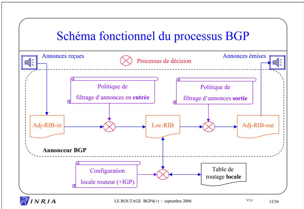
Noter la flèche à double sens entre la table Loc-RIB et le processus de décision en bas du schéma. En effet, si c'est bien la table Loc-RIB qui permet au final de bâtir la table de routage, elle reçoit aussi des informations sur les routes locales de l'AS à travers des directives du fichier de configuration (annonces statiques ou redistribution des routes apprises par l'IGP dans BGP).
