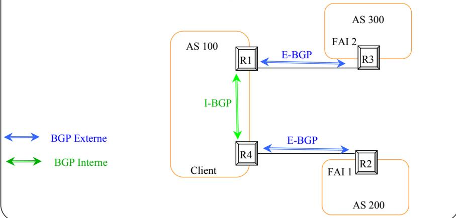
Ce schéma correspond au cas classique d'un client qui se connecte à deux fournisseurs pour s'assurer une protection contre la défaillance de l'un d'entre eux ou de l'un de ses routeurs de bord R1 ou R4.
