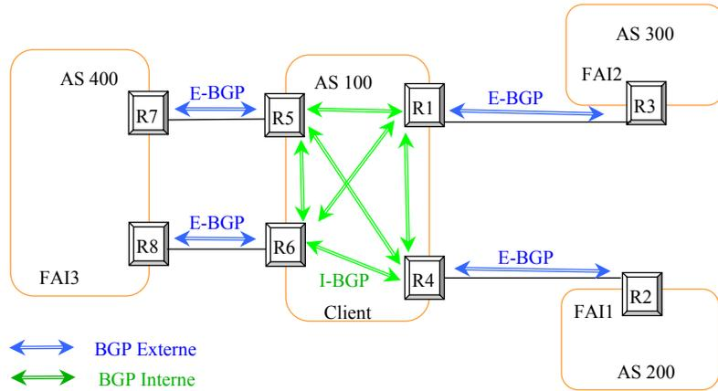
Noter le maillage complet de sessions I-BGP entre R1, R4, R6, R5 dans l'AS 100. Pour les autres AS, les 4 routeurs de bord de l'AS 100 sont vus, du point de vue fonctionnel comme un seul routeur (avec 4 interfaces).
